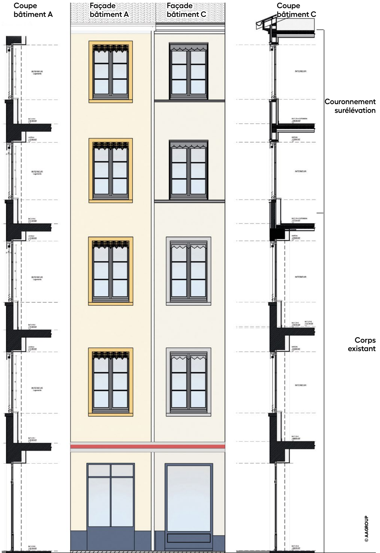
À gauche, façade du bâtiment A. À droite, un exemple de réinterprétation des menuiseries en fonction de la partie restaurée, réalisées en métal et en joint creux pour signifier leur contemporanéité.
